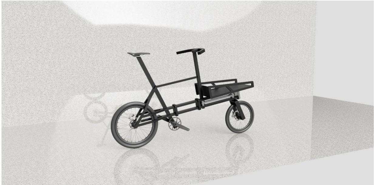
Gebaut werden soll ein fahrtüchtiges und sehr kostengünstiges Lastenrad aus Multiplex Sperrholz mit Zahnriemenlenkung. Zum Einsatz kommen verschiedenste Fertigungsverfahren. Ein grober Entwurf ist vorgegeben.
